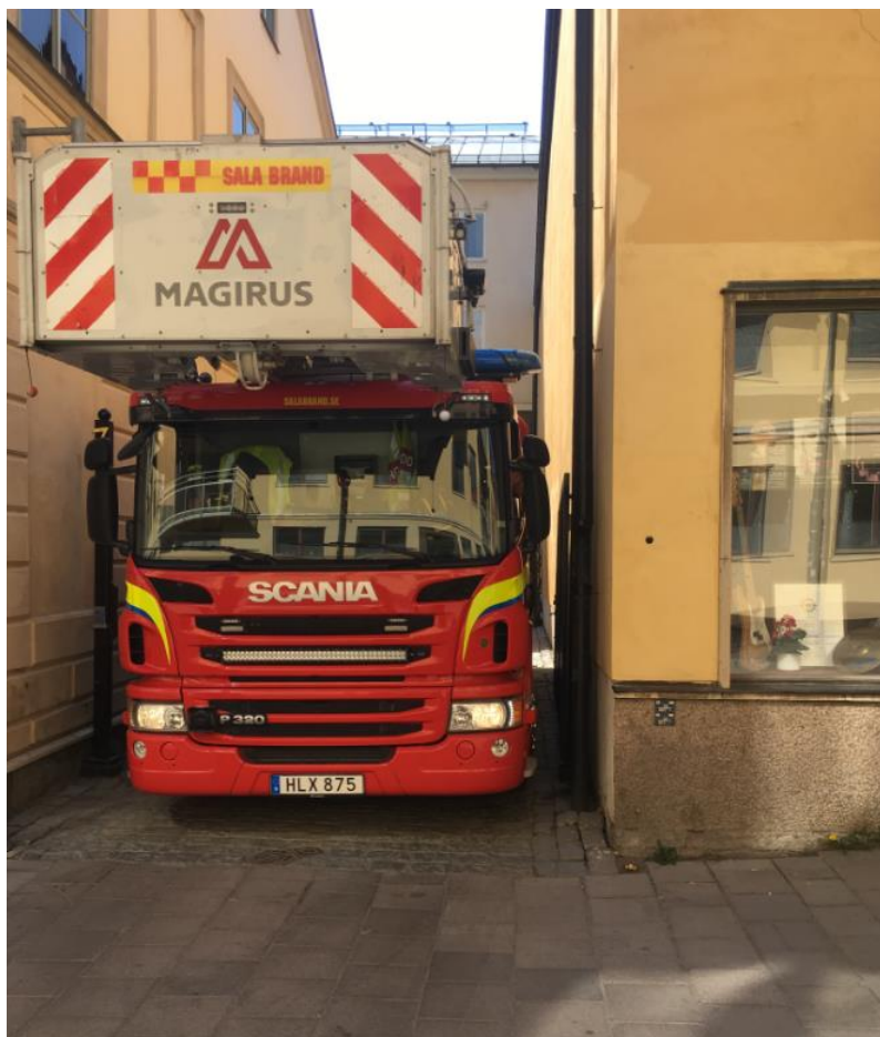
Figur 4. Exempel på en räddningsväg med 3,0 meter fri bredd. Det är viktigt att det finns extra utrymme i sidled när det finns sidohinder, både för att underlätta inkörning och för att personal ska kunna passera fordonet och ta sig in och ut. För att göra en effektiv insats kräver vi därför en bredd på 3,5 meter genom portaler eller vid utstickande sidohinder.
