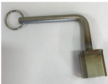
Figur 2. Brandpostnyckel enligt SMS 1188 anpassad för öppning av luckor.
